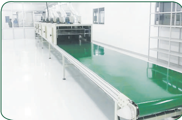
HỆ THỐNG BĂNG TẢI SẤY / DRYING CONVEYOR SYSTEM
